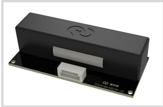
DSH01M-M50K-JS 红外甲烷传感器采用了 NDIR 红外吸收检测原理，采用单光源、双通道探测器，实现了双光路参比补偿。用微处理器进行信号采集、处理和输出，实现了环境温度补偿，修正了原理上非线性关系，并具有多种输出形式。最低使用温度延伸到了-25 摄氏度，可适用于家用报警器、暖通设备、农业、畜牧业等场所。
